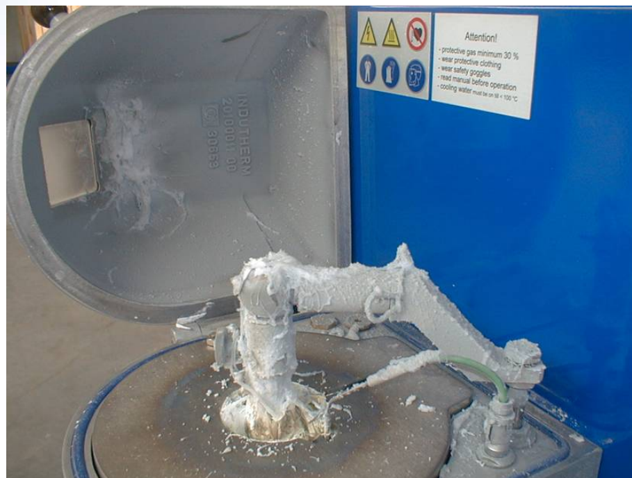
Перегрев сплава с 25% цинка
