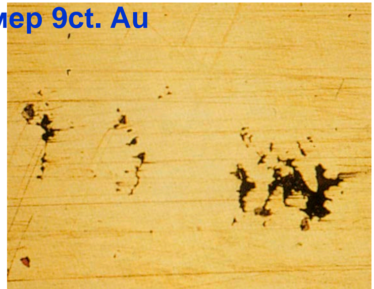
„Следы ворона“-дефект поверхности – вызван оксидами включений
