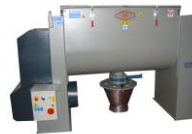
Miscelatore per polveri da recupero Powder mixer
