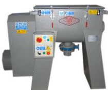
Miscelatore per polveri da recupero Powder mixer
